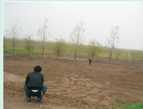
▲ 川气东送工程管道作业带土地整治水土保持监测
