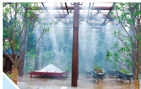
▲ 蔡甸区鸪翅岭科技示范园人工模拟降雨设施
