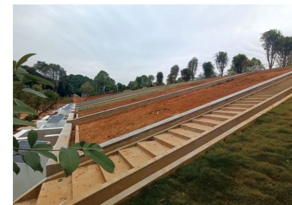
高腊梅港小流域监测点新建坡面径流小区
