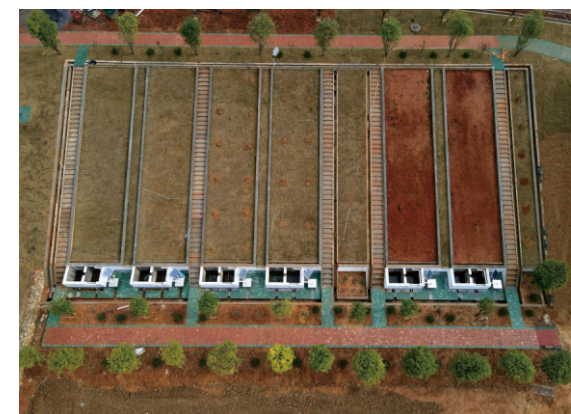
高腊梅港小流域监测点新建坡面径流小区
